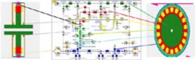
شکل ۱۹ - تطابق مدلهای محوری و شعاعی موتور با مدل حرارتی
